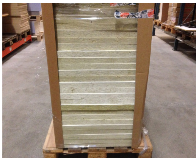
Bild 6. Stapling och stabilisering av akustikplattor.
