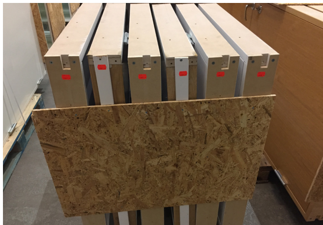
Bild 4. Lastsäkra dörrpartierna med hjälp av skivmaterial, gärna med litet avstånd emellan för att undvika skrapmärken. Sätt en skruv i ovankant och en i nederkant.
