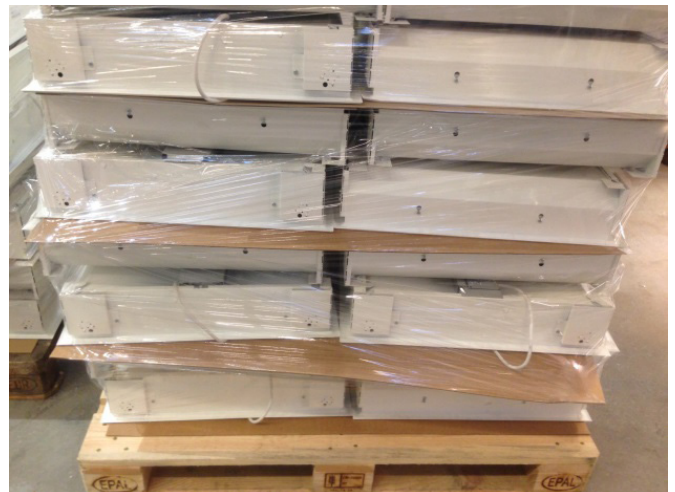
Bild 2. Stapling av infällda armaturer på lastpall.
