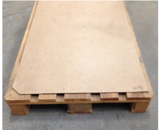
Bild 1. Bottenskiva av wellpapp, masonit eller motsvarande skyddar och förhindrar att mindre delar faller igenom lastpallen.
