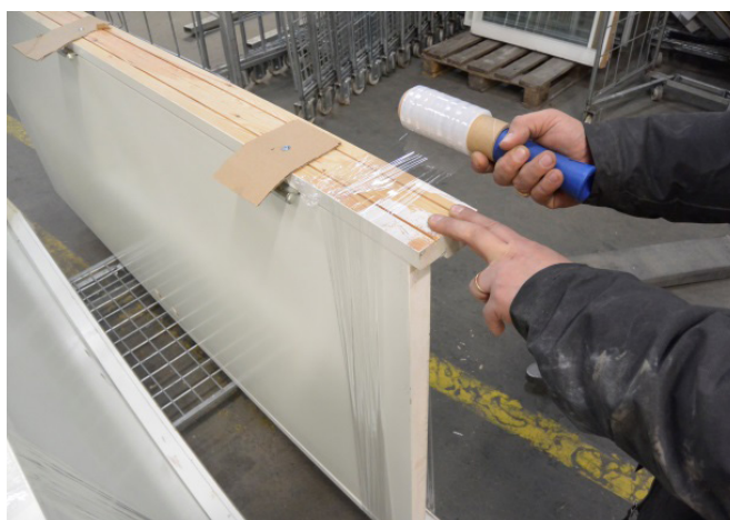
Bild 6. Fäst samman dörr och karm å dörrpartier utan trösklar för att förhindra att dörren går upp under transport och hantering.
