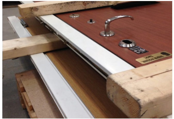
Bild 7. Träreglar förhindrar att utstickande delar som dörrhandtag och gångjärn skadas.
