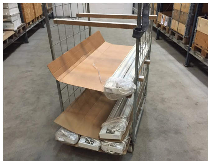
Bild 3. Stapling av pendelarmaturer i lastbur.
