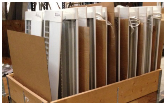
Bild 6. Stabiliseringsband håller samman pallkragarna med lastpallen och hindrar armaturerna från att välta.
