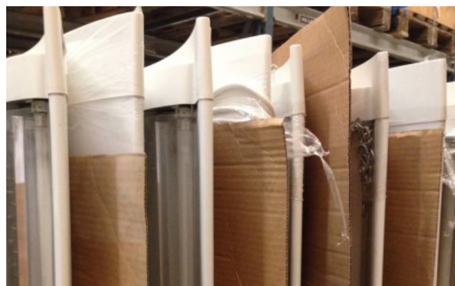
Bild 5. Hantering av pendelarmaturer med skyddande kartong emellan.
