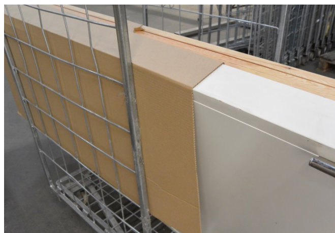
Bild 8. Skydda karmarna med wellpapp för att undvika skavmärken från lastburen.
