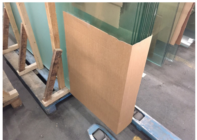
Bild 2. Skydda utstickande delar med wellpapp eller liknande.
