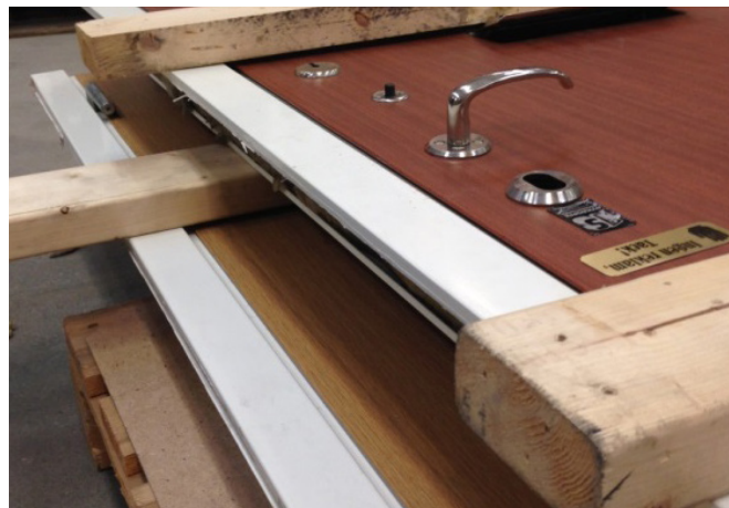
Bild 7. Träreglar förhindrar att utstickande delar som dörrhandtag och gångjärn skadas.
