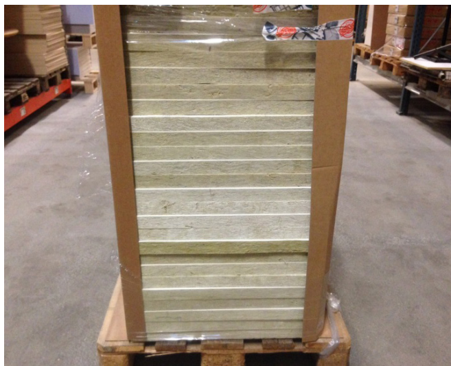
Bild 6. Stapling och stabilisering av akustikplattor.
