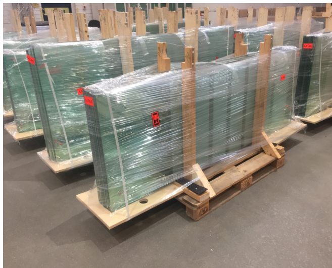
Bild 4. Säkra glaspartierna med träreglar så de inte välter. Det är inte nödvändigt att linda plast runt.
