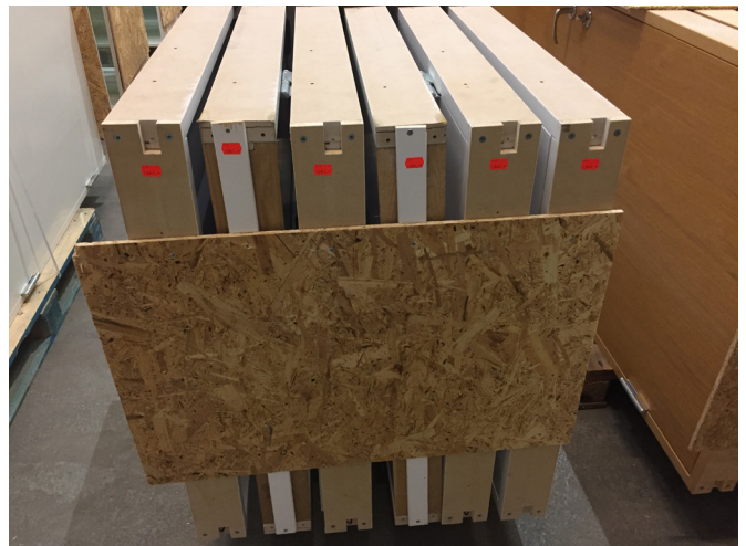
Bild 3. Lastsäkra karmförsedda glaspartier med skivor som fästs med en skruv i ovankant och en i nederkant i varje enhet.
